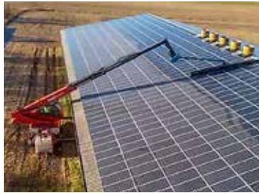
Die mobile sunBrush, angebaut an einen Manitou, kommt auf großen PV-Aufdachanlagen zum Einsatz. Foto: dührsen
