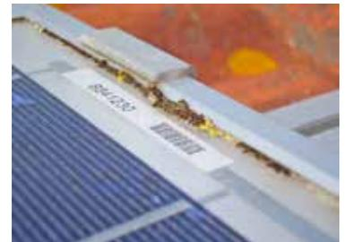
Bei einem starken Algenbefall können die Wurzeln bis zur Dichtung wachsen und somit das Modul irreparabel beschädigen.
