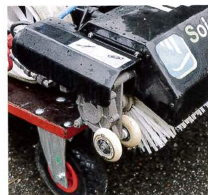
Die kleinen Stützräder vorne heben die Bürste beim Überfahren von Gängen an und verhindern, dass der Elektromotor des Bürstenantriebs auf die Module aufsetzt.
