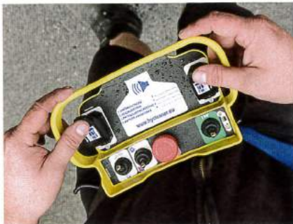
Mithilfe der zwei kleinen Hebel an der Fernbedienung lenkt der Bediener den hyCleaner.
