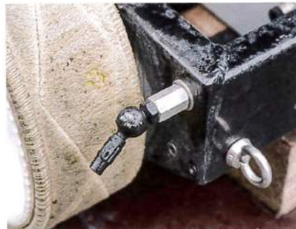
Die Düse sprüht zum Vorweichen Wasser auf die Module. Sie lässt sich von Hand abstellen.
