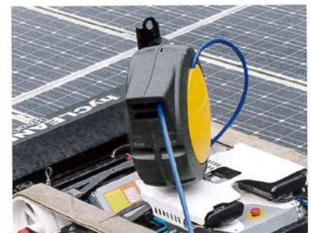
Der Schlauchaufroller wickelt 20 m Wasser-schlauch automatisch auf.
