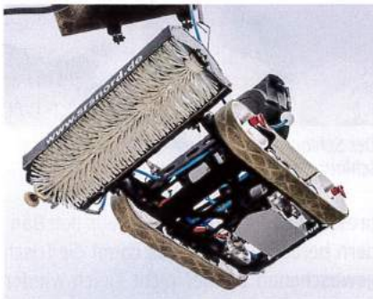
Ein Blick von unten: Die Bürste hat 30 cm Durchmesser.
